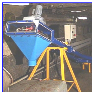
Przenośnik zgrzeblowo - rurowy firmy FERIND w laboratorium Katedry Maszyn Górniczych, Przerobczych i Transportowych AGH
