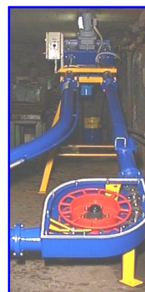
Przenośnik zgrzeblowo - rurowy firmy FERIND w laboratorium Katedry Maszyn Górniczych, Przerobczych i Transportowych AGH
